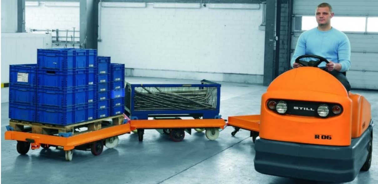
Obrázek 2 - Tahač typu R06 s připojenou hydraulickou tažnou soupravou E-rámů [9]
