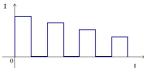
Obrázek 44 - Průběh proudu při pulzním nabíjení se změnou amplitudy [13]
